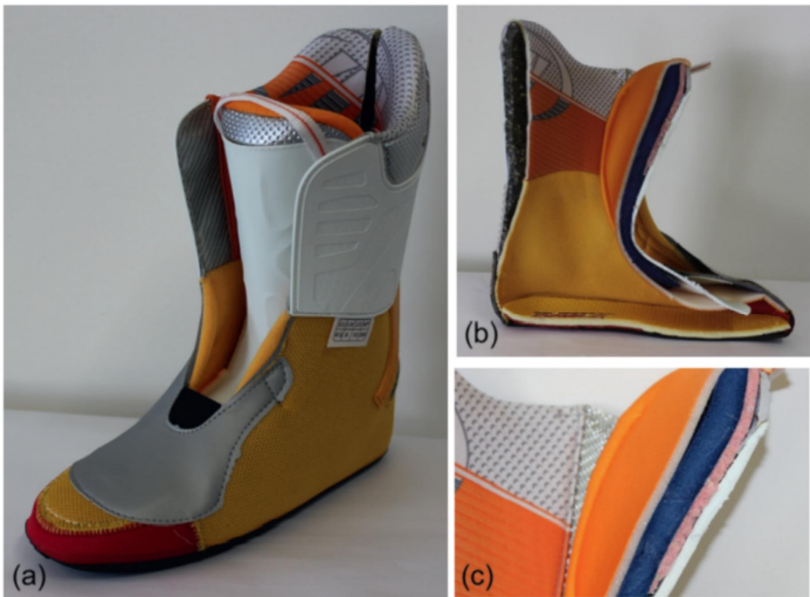
图 (a) 滑雪靴衬垫 (b) 不同层次的滑雪靴衬垫的横截面图 (c) 鞋舌的详细视图
